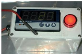
elektronisches Thermometer mit Temperaturfühler – zur regelmässigen Kontrolle von Thermometern auf Pasteurisations- und Abfüllstationen
