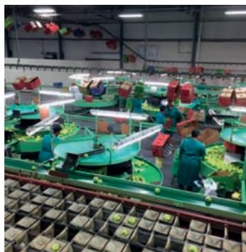
Apfelsortieranlage – Grössensortierung mechanisch, Abpacken von Hand
