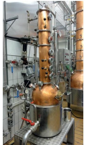
Ein langsames Destillieren ermöglicht eine saubere Vorlauf-Abtrennung.
