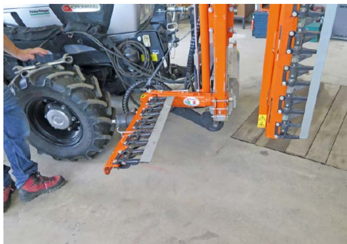
Beispiel von Messerbalken mit horizontalen Messern für die Begrenzung im unteren und oberen Baumbereich und vertikalem Balken
