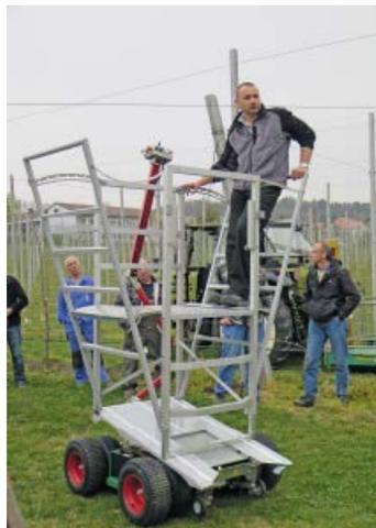
werden, das garantiert bessere Stabilität, höhere Geschwindigkeit und längere Batterieleistung. Eine 3-Punkt-Transport-Vorrichtung ermöglicht den Transport des Geräts aufs Feld. Die Fahrgeschwindigkeit ist konstant regulierbar und auf eine Strecke vorprogrammierbar.
