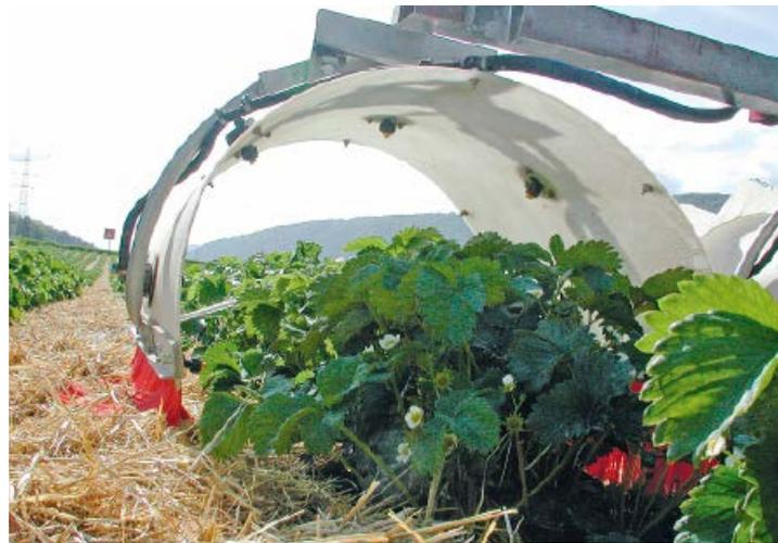
Tunnelbandsprayer «klip-klap, mit 3 bis 5 Düsen pro Reihe», ([www.skovhave.dk](http://www.skovhave.dk) / Reihenspritzgeräte)
