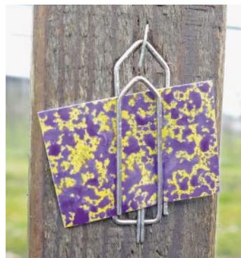
Vergleich der Spritzbilder. Links mit Injektor Düsen bei 10 bar und rechts mit Hohlkegeldüsen bei 10 bar
