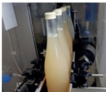
Pasteurisation und Heissabfüllen in 0.7l Flaschen mit Schraubverschluss.
