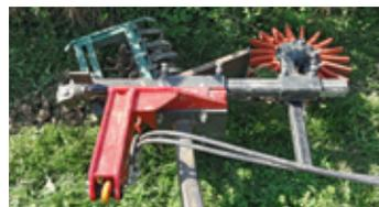
4fach Rollhacke mit Fingerhacke – Hohe Flächenleistung erfordert hohe Fahrgeschwindigkeit bei sehr hohem Kraftaufwand und starkem Verschleiss der Lager.
