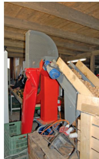
Der Separator trennt mit einem Luftstrom die leeren Nüsse von den guten.
