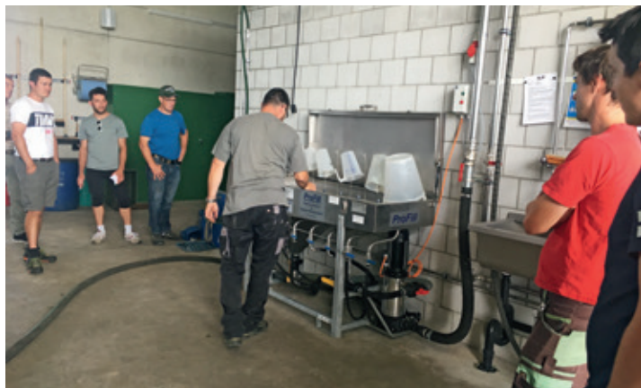
Mit einer Einspülschleuse vereinfacht sich das Anrühren der Spritzbrühe.
