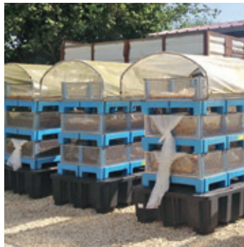
Beim Osmofilm handelt es sich um einen speziellen Behälter, aus dem Wasser verdunsten kann und Pflanzenschutzmittelreste im Sack zurückbleiben. (Bild: https://axe-environnement.eu )
