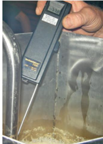
Laufende Temperatur-Überwachung beim Abfüllen.
