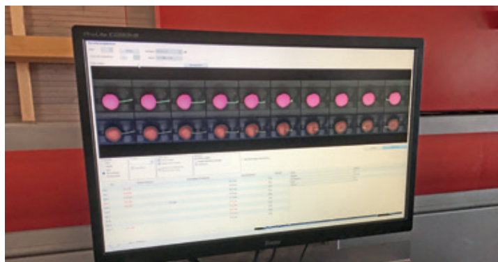
Die Sortiermaschine der STAS fotografiert eine Kirsche 20–30 mal. Dabei sollen auch Schäden oder Befall durch die Kirschessigfliege erkannt werden.
