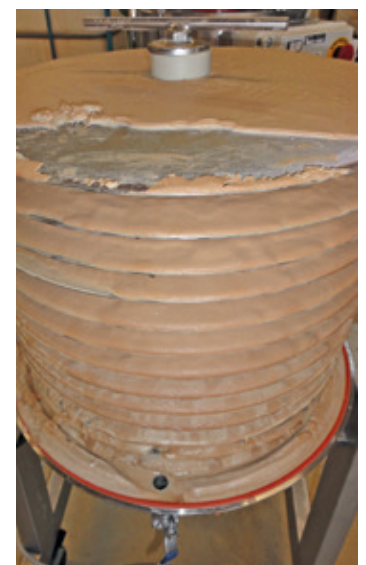
Kieselgur-Anschwemmfilter nach der Filtration – braune Trubstoffe werden von Kieselgur zurückgehalten.
